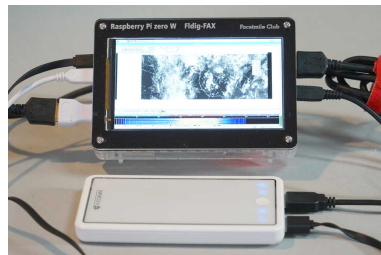
raspberry pi Zeroを組み込んだ高精細モニターバッテリーで動作している
