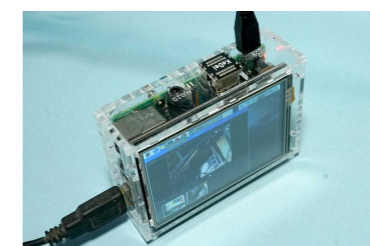
モニターをラズパイ3Bに取り付けケースに
