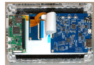
ケース内部左端が Raspberry pi Zero 右はインターフェース基板
