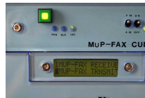
上段が5インチベイに組み込んだMuP-FAX部分で、左寄りの四角いボタンが切り替え制御用のプッシュスイッチ。切り替え選択が決定されるとスイッチ内のLEDが点灯する。下の3.5インチベイにLCD表示部を組み込んである。
