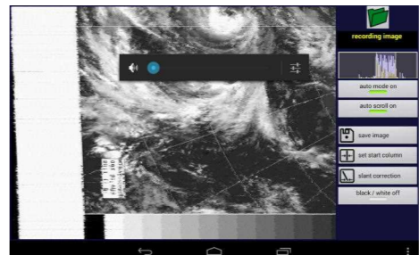
NEXUS 7でJMHを受信しているところグレースケールの表示が可能。
